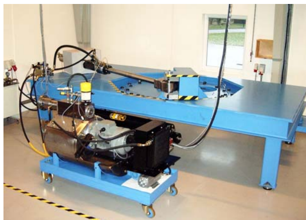
Instalación de ensayo para actuador de cambio de paso hidráulico
