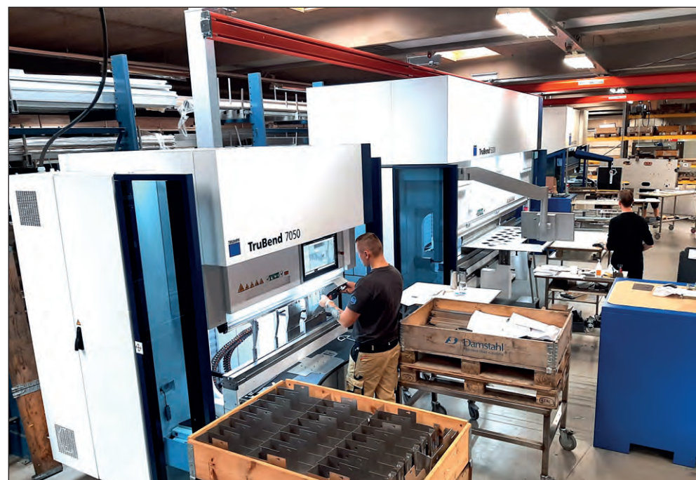
Hos Claus Andersen Rustfri Stål fortsætter man rækken af investeringer. Senest er det med en Trumpf TruBend 7050-kantpresse.
