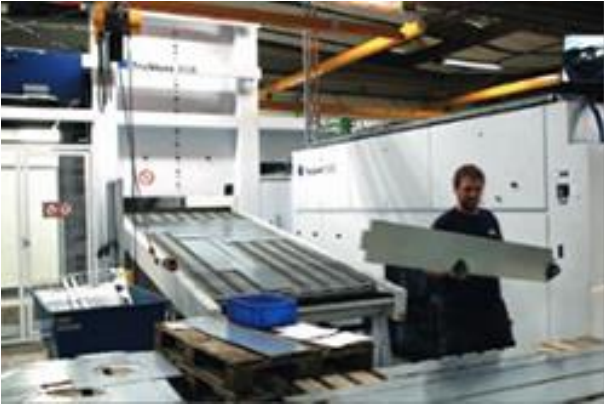
Med Part-Master-modulet separeres emnerne fra den færdigskårne plade ved at lade tyngdekraften gøre arbejdet, når pladen kører ud på det skrå plan. Dermed bliver det langt lettere for operatørerne at tage fat i emnerne. Foto Teknovation.dk.
