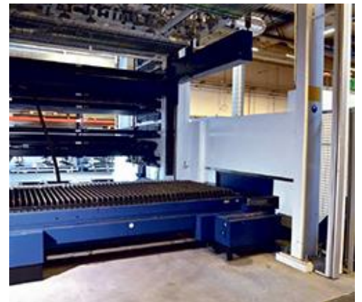
Tårnet med automatisk håndtering af materialer styrker konkurrenceevnen på laserskæring. Foto Teknovation.dk.
